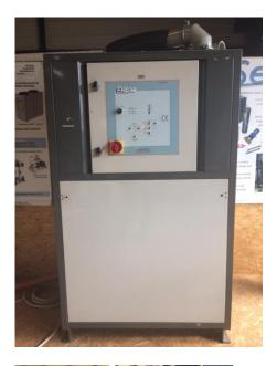
Dessiccateur de marque EQUIPTEC EH4 3 z Dessiccateur à roue 450 m3/h pour trémie maxi 800 litres Puissance installée 8 Kw
