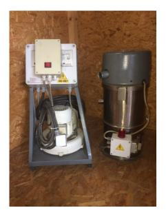
Aspirateur triphasé de marque MORETTO Turbine triphasé 750 w Livré avec 3m de tuyaux + canne d'aspiration.
