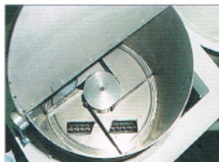
Doseur fond plat en inox Stainless steel anti bridging system.
