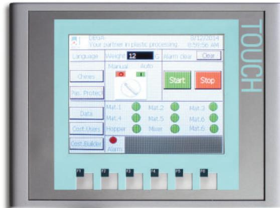
La programmazione e la gestione delle ricette è semplice ed intuitiva, sul controllo touch screen ogni funzione è segnalata con una simbologia che raffigura la parte che si sta programmando, ogni anomalia è raffigurata con la parte in allarme.
