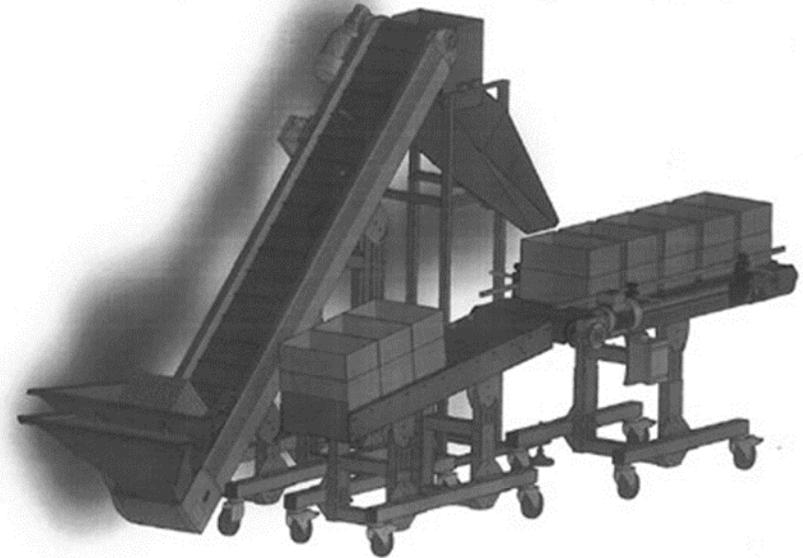
Comptage pièces par pesée et remplissage automatique des cartons
